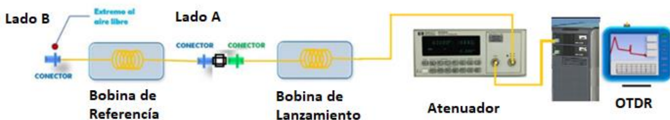
Figura 14. Sistema para la calibración de la escala de atenuación del OTDR.
